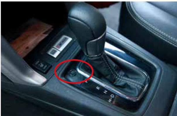
您是否注意过自动挡车型，排挡附近的一个不起眼的小按键？我们知道从P挡挂入其他挡位的时候需要按下挡把上的一个类似“解锁”按钮，否则挡把无法移动。但车辆出现故障没电了后，“解锁”按钮就失效了，但需要将车移动时，就需要按下这个小按键了。
