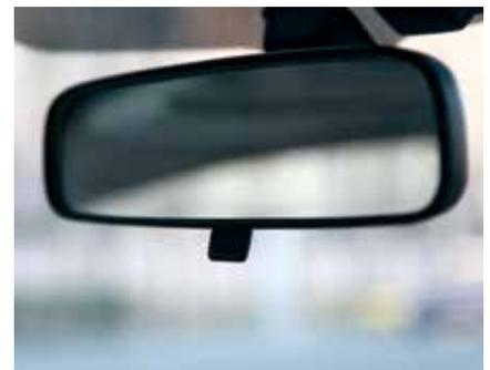
对于防眩目后视镜，很多人会认为这是一个高端车型才会匹配的功能，其实市面上绝大多数车辆的后视镜都具有防眩目功能，只要扳下后视镜下面的这个钮，就可以实现。它的原理并不复杂，它是靠一个横截面被切割成上面厚，下面薄的楔形镜子实现的，如果有兴趣可以到汽配城买一个便宜的后视镜，拆下玻璃，自然就解开了其中的玄机。
